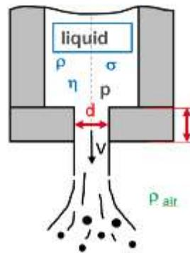
**Figure 2 Turbulent jet decomposition**
